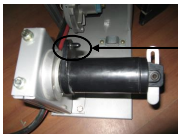
阻尼式焊丝盘 支撑轴固定销
